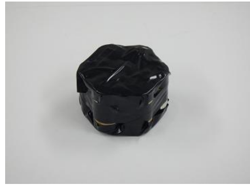
(電池端子連結部の被覆 ／電池の固定)
