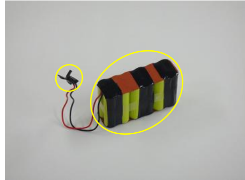
(電池端子連結部当て板の固定 ／コネクター部の被覆)
