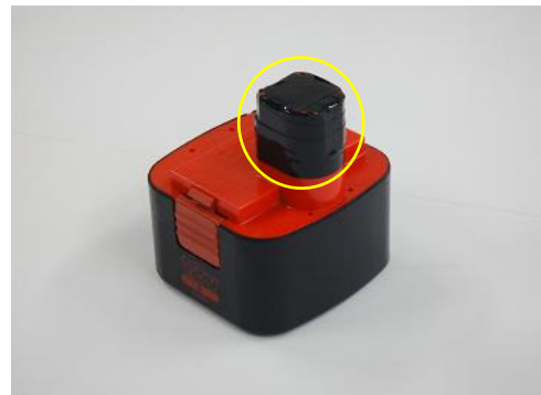
(電極端子部の被覆)
