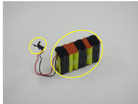
(電池端子連結部当て板の固定 ／コネクタ部の被覆)
