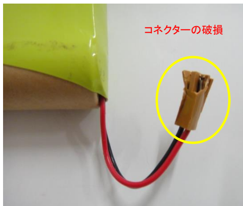
(コネクタ部の破損) コネクタ内でリード線同士が接触し 短絡の可能性あり
