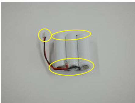
(電池端子連結部/コネクタ部の露出)
