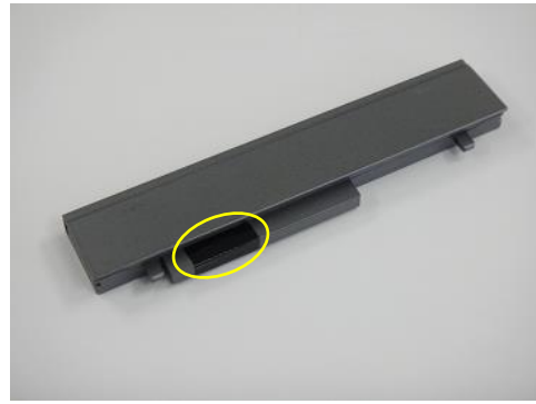
(電極端子部の被覆)
