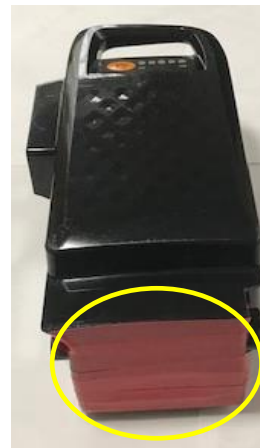
(アシスト自転車用電池の端子部を絶縁)
