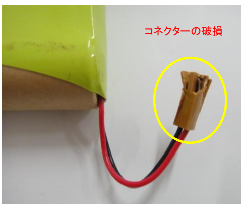
(コネクター部の破損) コネクター内でリード線同士が接触し 短絡の可能性あり
