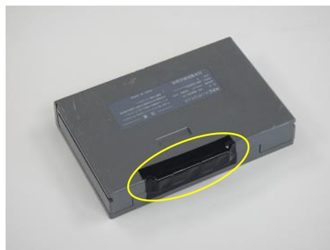
(電極端子部の被覆)
