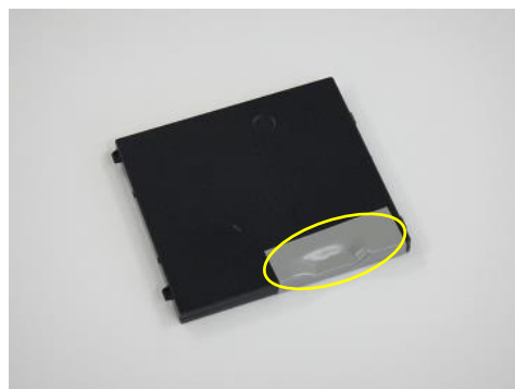
(電極端子部の被覆)
