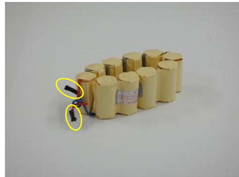
(リード線切断部の被覆)
