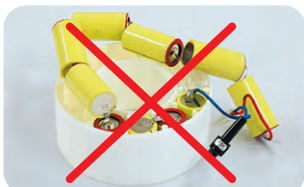
電池パックから外れかけた連結電池
