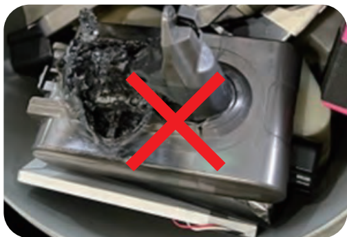
クリーナー用非純正電池での発熱事例
